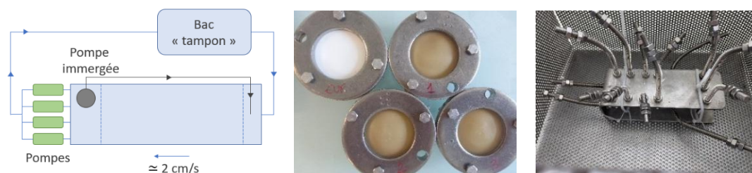
Figure 1 : a. Chenal pilote - b. Membranes avant extraction (Blanc terrain et membranes immergées dans l'eau usé) - c. Dispositif pour le dépôt des disques en STEU
